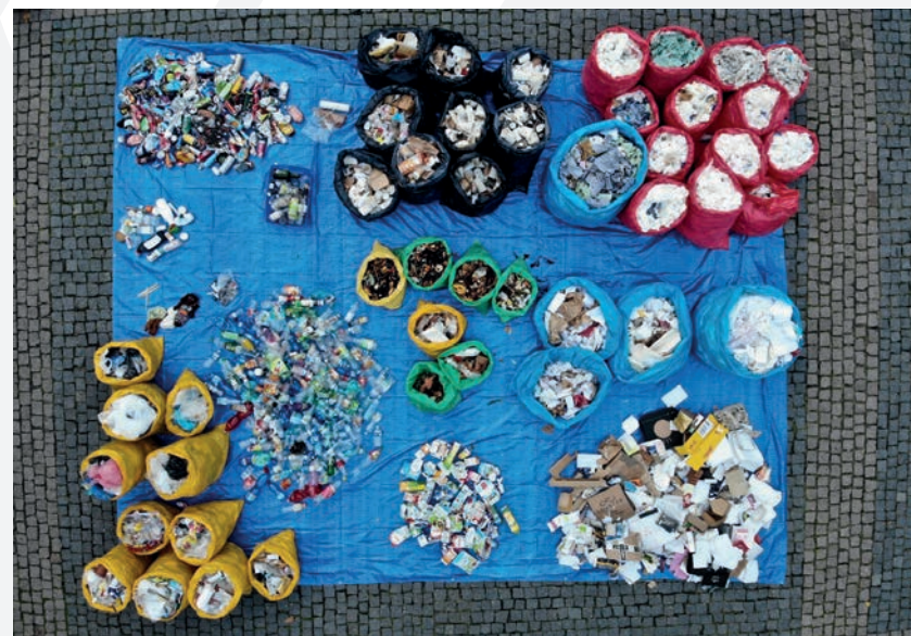
Obrázek 2: Vzorek směsného komunálního odpadu o hmotnosti 210,5 kg, roztřízený při fyzické analýze na jednotlivé druhy
