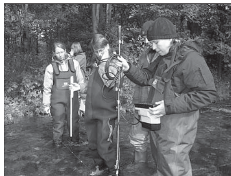
▲ Měření rychlosti proudu a výpočet průtoku
