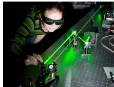
Rutinní, leč zajímavá práce v laboratoři: justování koutového odrazce
