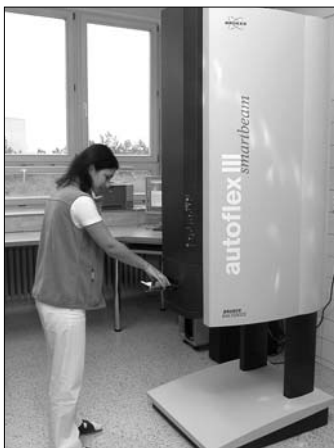
▲ Hmotnostní spektrometr MALDI-TOF používaný k proteomickým studiím
