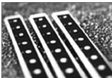
▲ Proteinový čip: Na povrch o průměru 3 mm se aplikuje analyzovaný vzorek
